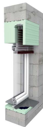
THERMO-FBA-SHADOW Fensterbank-Anschluss mit Raffstorekasten-System von Beck+Heun
