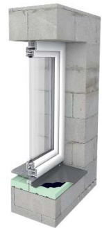
THERMO-FBA-UNI Fensterbank-Anschluss ohne Beschattungseinheit
