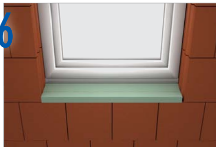
6 Fenster abschließend einsetzen
