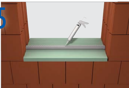
5 Fensterbank-U-Profil ebenfalls mittels Silikon verkleben
